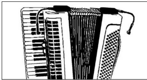
Fig. 6: Microfonar o acordeão com dois C 616 ML
