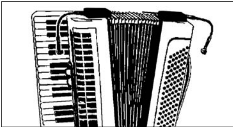
Abb. 6: Akkordeonabnahme mit zwei C 516 ML
