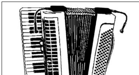
Fig. 6: Ripresa di fisarmonica con due C 516 ML
