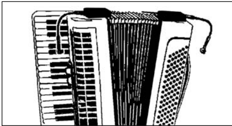
Fig. 6 : Prise de l'accordéon avec deux C 516 ML
